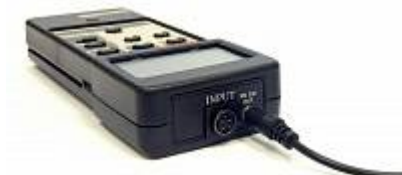
ACE-1026 Преобразователь интерфейсов RS-232 - USB - Разъем RS-232 и jack 3,5 мм в подключенном состоянии
