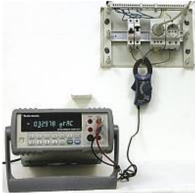
АСМ-1803 Токовые клещи - Измерение переменного тока - аналоговый выход, мультиметр
