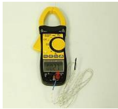
АСМ-2031 Токовые клещи - Измерение температуры
