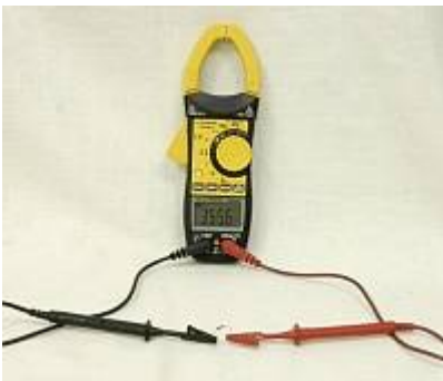
АСМ-2031 Токовые клещи - Измерение сопротивления
