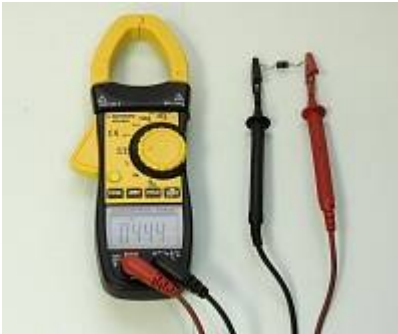
АСМ-2031 Токовые клещи - Проверка диода
