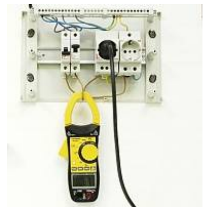
АСМ-2031 Токовые клещи - Измерение переменного тока
