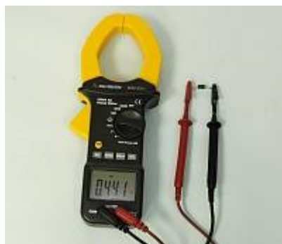
АСМ-2311 Токовые клещи-мультиметр - Прозвонка диода
