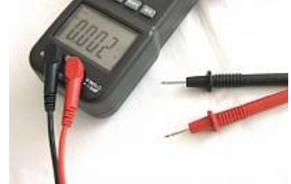
АСМ-2311 Токовые клещи-мультиметр - Подключение щупов
