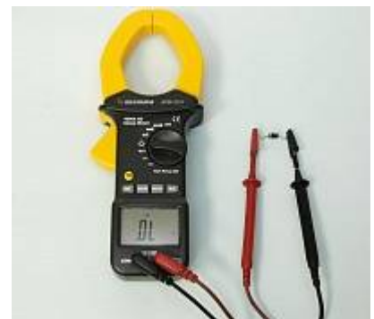
АСМ-2311 Токовые клещи-мультиметр - Прозвонка диода
