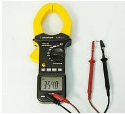
АСМ-2311 Токовые клещи-мультиметр - Измерение сопротивления
