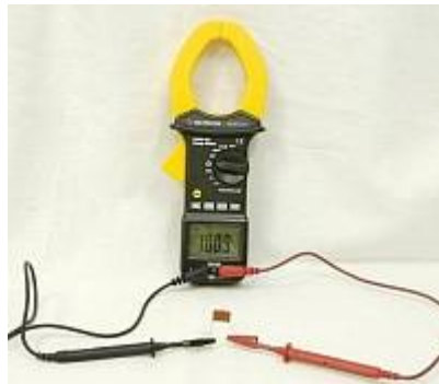
АСМ-2311 Токовые клещи-мультиметр - Измерение ёмкости
