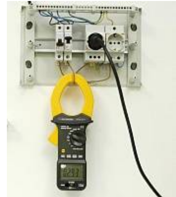
АСМ-2311 Токовые клещи-мультиметр - Измерение переменного тока
