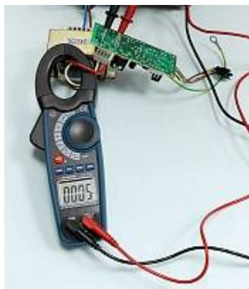
АСМ-2348 Токовые клещи-ваттметр - Измерение мощности
