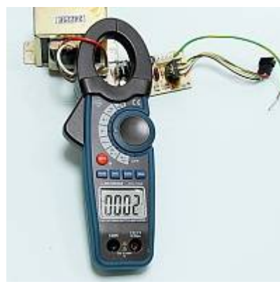
АСМ-2348 Токовые клещи-ваттметр - Измерение переменного тока
