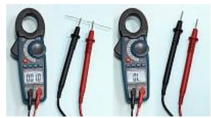
АСМ-2348 Токовые клещи-ваттметр - Прозвонка цепи
