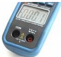
АСМ-2348 Токовые клещи-ваттметр - Входные разъемы
