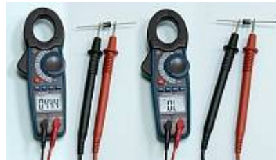
АСМ-2348 Токовые клещи-ваттметр - Тест диодов
