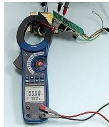
АСМ-2353 Токовые клещи-ваттметр - Измерение реактивной мощности (первая строка) и полной мощности (вторая строка)
