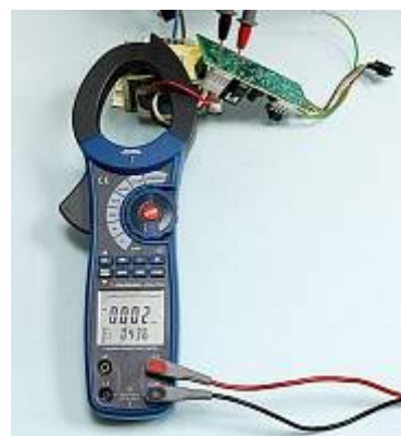
Справа: АСМ-2353 Токовые клещи-ваттметр - Измерение энергии (первая строка) и времени (вторая строка)
