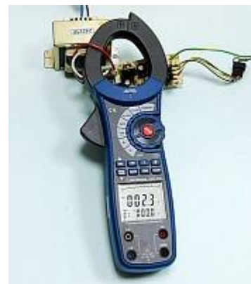
АСМ-2353 Токовые клещи-ваттметр - Измерение переменного тока (первая строка), возможно также отображение переменного напряжения (вторая строка)
