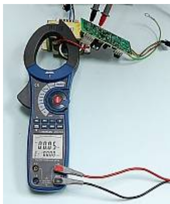
АСМ-2353 Токовые клещи-ваттметр - Измерение полной мощности (первая строка) и реактивной мощности (вторая строка)
