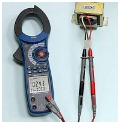
АСМ-2353 Токовые клещи-ваттметр - Измерение переменного напряжения (основной дисплей) и частоты (второй дисплей)
