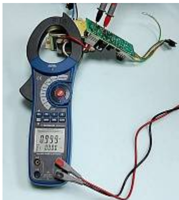
АСМ-2353 Токовые клещи-ваттметр - Измерение активной мощности (первая строка) и фазового угла (вторая строка)
