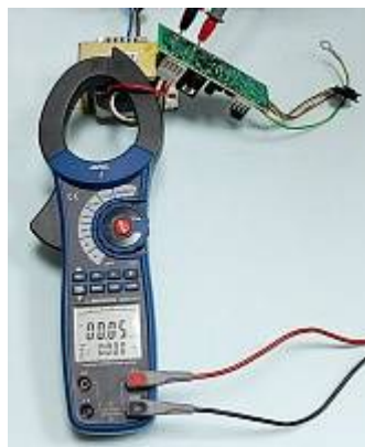
АСМ-2353 Токовые клещи-ваттметр - Измерение активной мощности (первая строка) и фазового угла (вторая строка)
