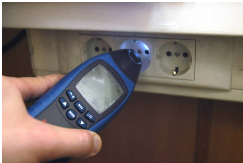
Бесконтактный датчик напряжения и встроенный фонарик
