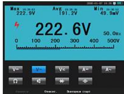
Осциллограф цифровой ручной - дисплей мультиметра
