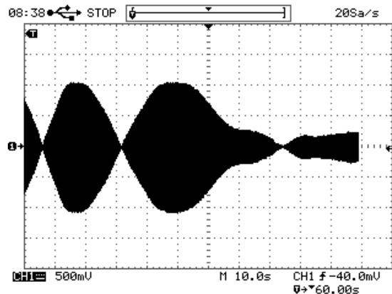
На втором экране развертка установлена в положение 10 с/дел, а частота дискретизации на такой развертке получилась 20 выборок в секунду (20 Sa/s). Т.е. на один период сигнала 20 мс пришлось:  $20E-03(\text{сек}) * 20(1/\text{сек})=0,4$  точки. Т.е. восстановить (интерполировать по точкам) синусоиду, имея меньше одной точки на период невозможно, поэтому вы получили мешанину (т.н. "aliasing" или ложные частоты), образованную биениями измеряемой частоты и частоты дискретизации.
