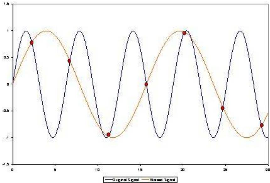
Чтобы корректно устанавливать режим сбора данных цифрового осциллографа следует придерживаться простого правила: частота дискретизации должна быть по крайней мере в 5-10 раз выше частоты сигнала, тогда у вас не будет парадоксов, которые наблюдаются на втором экране.
