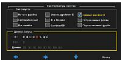
Осциллограф цифровой ручной - параметры запуска по сигналам CAN
