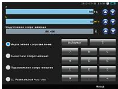
Осциллограф цифровой ручной - система расчёта электрических величин
