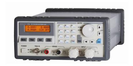
Электронная программируемая нагрузка. Напряжение на входе 0-80 В, ток на входе 0-40 А, потребляемая мощность 400 ВА. Режимы стабилизации СС, СV, СR, СР. Работа по спискам. Тестирование батарей. Режим КЗ. Программируемый выход: сопротивление, ток, мощность, комбинированный. LCD- дисплей. Интерфейс - RS-232. SCPI-программирование
