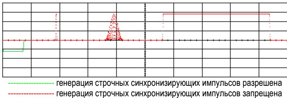
Установленные таким образом амплитуды выдерживаются на нагрузке 1 МОм. Однако в связи с тем, что стандартное входное сопротивление низкочастотного видеовхода телевизора составляет 75 Ом, программа может удерживать заданную амплитуду и на 75-омной нагрузке (амплитуда, установленная на 1 МОм в этом случае возрастает вдвое). Указать сопротивление нагрузки можно с помощью соответствующего флашка на панели регулировки амплитуды.
