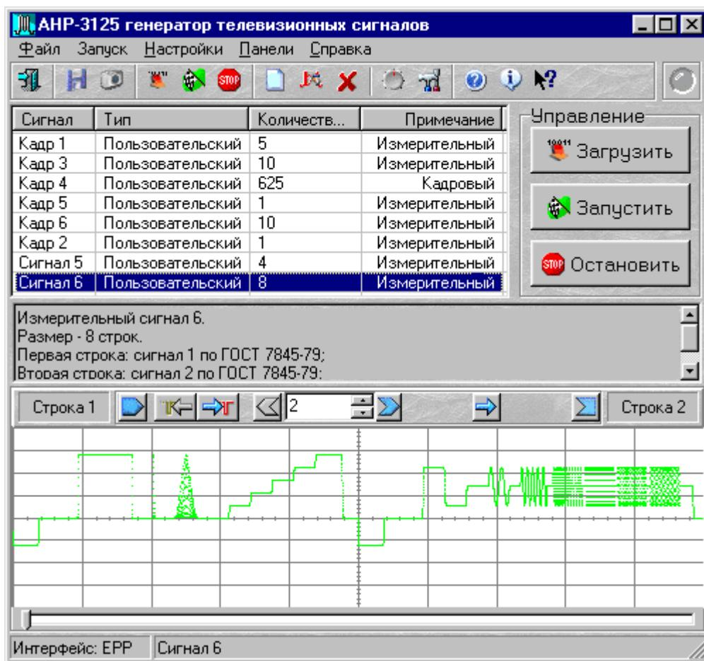
В верхней части главного окна расположен список стандартных и пользовательских сигналов, содержащихся в базе данных программы. Под ним краткое описание выделенного сигнала и его «осцилограмма». Управляющие элементы, расположенные в главном окне, позволяют пользователю загружать в генератор, просматривать целиком и частями (см. «Параметры «осцилограммы»), распечатывать, редактировать и создавать новые измерительные сигналы, запускать и останавливать генератор.
