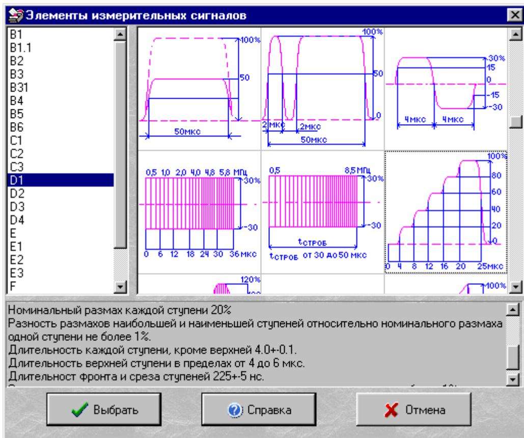
Панель библиотека стандартных элементов измерительного сигнала предназначена для выбора стандартных элементов, добавляемых в измерительный сигнал. В верхней части окна расположены список стандартных элементов измерительного сигнала, предусмотренных ГОСТ 18471-83, и графическое изображение каждого сигнала с его основными параметрами. Ниже в окне размещено описание выделенного элемента по ГОСТ 18471-83.
