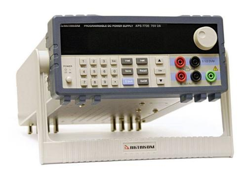
75 В/2 А. Прецизионный. Линейный. Программируемый. 1 канал. Вакуумно-флюорисцентный дисплей. Разрешение установки: 1 мВ/0,05 мА, считывания 0,1 мВ/0,01 мА. Точность установки 0,01%. Пульсации+шум 5 мВп-п/1 мАскз. Встроенный вольтметр и миллиомметр. Интерфейс: USB/RS-232. Программирование через SCPI команды. Габаритные размеры: 214х102х365 мм. Масса 6,5 кг.
