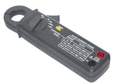
Токовые клещи-адаптер. Измерение постоянного (10 мА...200 А) и переменного (40 Гц...1 кГц) (1 мА...200 А) тока. Диаметр обхвата 23 мм. Базовая погрешность 1%. Питание 2х1,5 В. Поставляются в кейсе. Габариты 183х61,3х35,6 мм. Вес 190 г.
