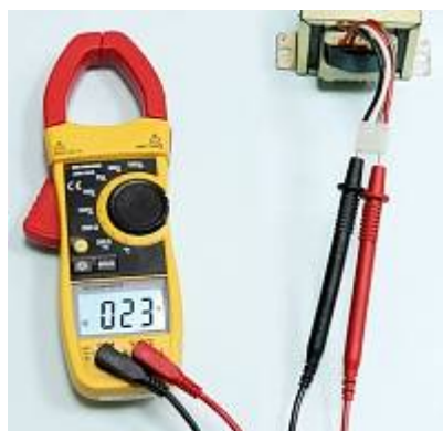
АТК-1010 Токовые клещи - Измерение переменного напряжения
