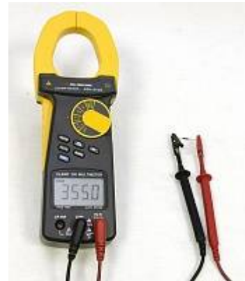
АТК-2103 Токовые клещи - Измерение сопротивления
