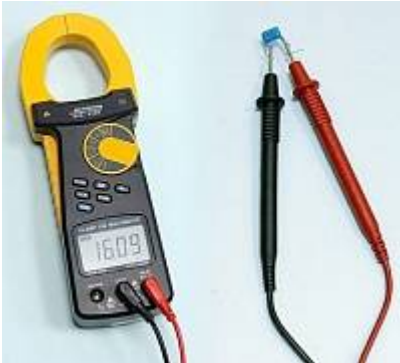
АТК-2103 Токовые клещи - Измерение емкости
