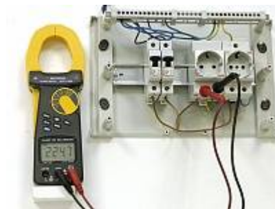
АТК-2103 Токовые клещи - Измерение переменного напряжения
