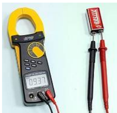
АТК-2103 Токовые клещи - Измерение постоянного напряжения
