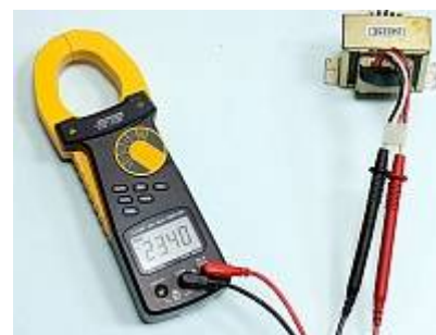
АТК-2103 Токовые клещи - Измерение переменного напряжения
