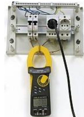
АТК-2103 Токовые клещи - Измерение переменного тока
