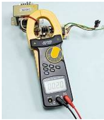
АТК-2103 Токовые клещи - Измерение переменного тока
