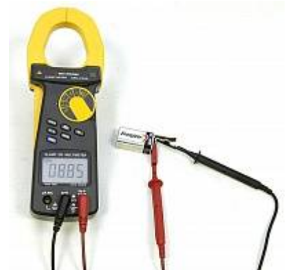
АТК-2103 Токовые клещи - Измерение постоянного тока
