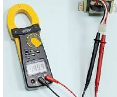
АТК-2103 Токовые клещи - Измерение частоты и коэффициента заполнения
