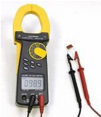
АТК-2103 Токовые клещи - Измерение емкости
