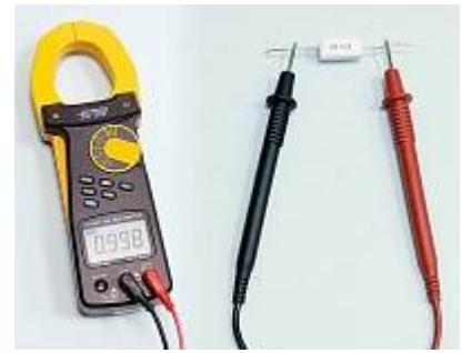
АТК-2103 Токовые клещи - Измерение сопротивления
