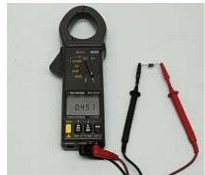
АТК-2104 Токовые клещи-ваттметр - Проверка диода
