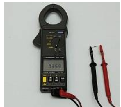
АТК-2104 Токовые клещи-ваттметр - Измерение сопротивления
