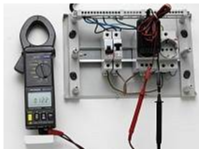
АТК-2104 Токовые клещи-ваттметр - Измерение постоянного напряжения
