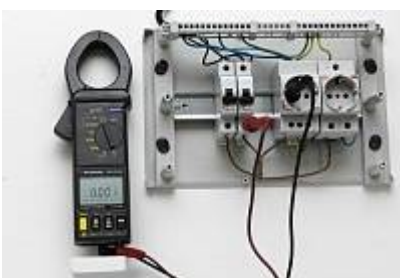
АТК-2104 Токовые клещи-ваттметр - Прозвонка цепи
