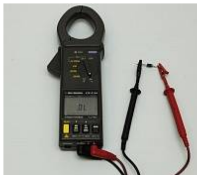
АТК-2104 Токовые клещи-ваттметр - Проверка диода
