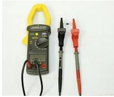
АТК-2209 Токовые клещи - Проверка диода
