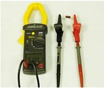
АТК-2209 Токовые клещи - Измерение ёмкости
