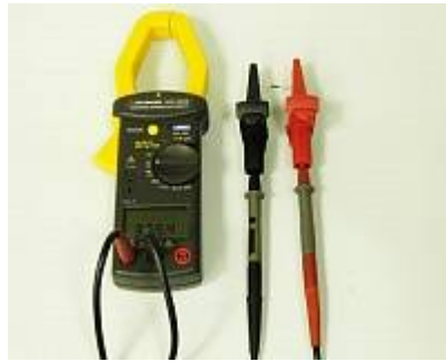
АТК-2209 Токовые клещи - Измерение сопротивления
