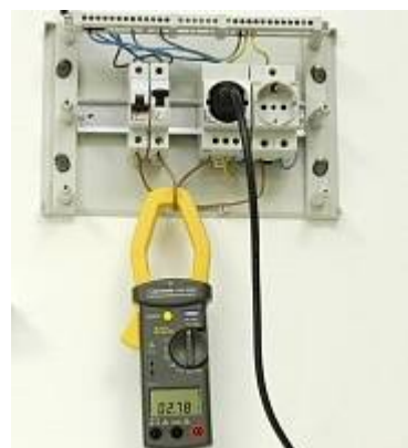
АТК-2209 Токовые клещи - Измерение переменного тока
