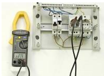
АТК-2209 Токовые клещи - Измерение переменного напряжения
