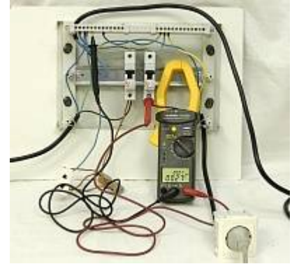
АТК-2209 Токовые клещи - Измерение мощности
