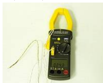
АТК-2209 Токовые клещи - Измерение температуры
