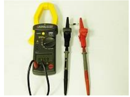
АТК-2209 Токовые клещи - Проверка диода
