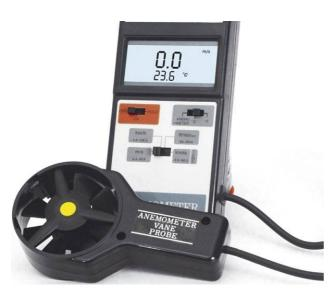
Крыльчатый термоанемометр с выносным датчиком для измерения скорости потока воздуха 0,8-30 м/с. Погрешность ±(0,2+0,04V) м/с. Измерение температуры воздушного потока (индикаторный канал). Удержание показаний. Поставляется в кейсе.
