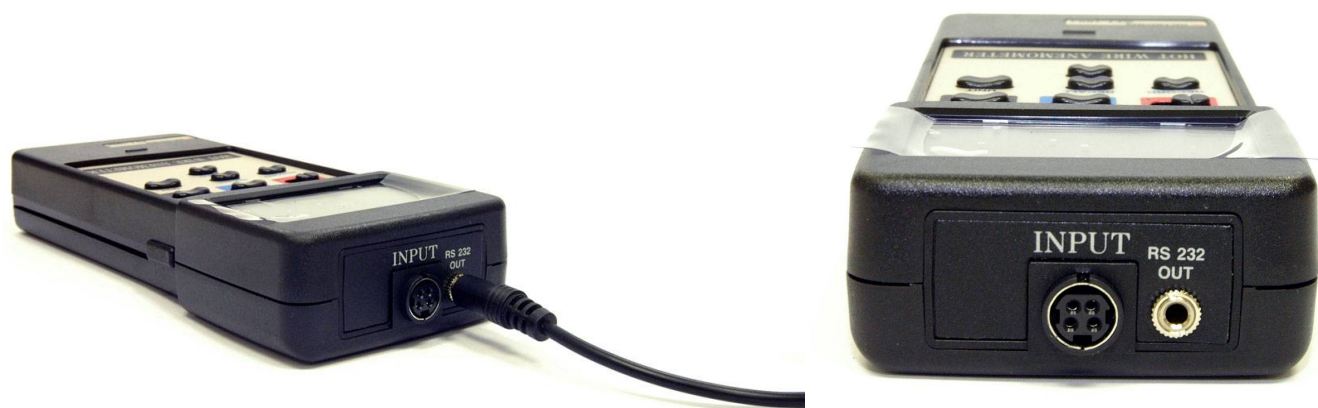
RS-232 и jack 3,5 мм в подключенном состоянии
