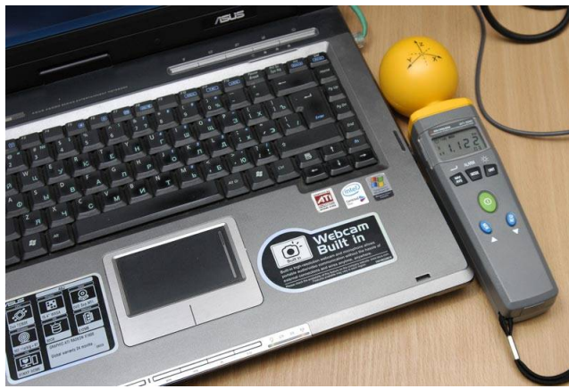
Измерение напряженности электрического поля ПК с включенным Wi-Fi. Максимальное значение составляет 1,122 В/м
