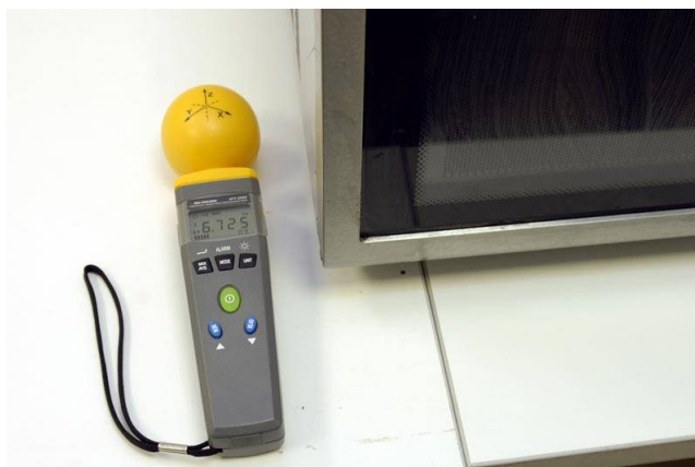
Измерение напряженности электрического поля СВЧ печи. Максимальное значение составляет 6,725 В/м
