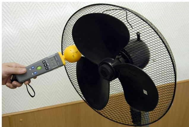
Измерение напряженности электрического поля выключенного вентилятора ("естественный" фон). Максимальное значение составляет 314,6 мВ/м
