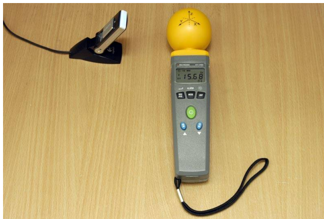
Измерение напряженности электрического поля Yota WiMax. Максимальное значение составляет 15,68 В/м
