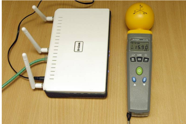
Измерение напряженности электрического поля Wi-Fi роутера. Максимальное значение 15,90 В/м
