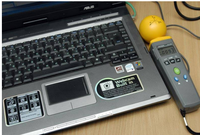
Измерение напряженности электрического поля ПК с выключенным Wi-Fi ("естественный" фон). Максимальное значение составляет 9,3 мВ/м
