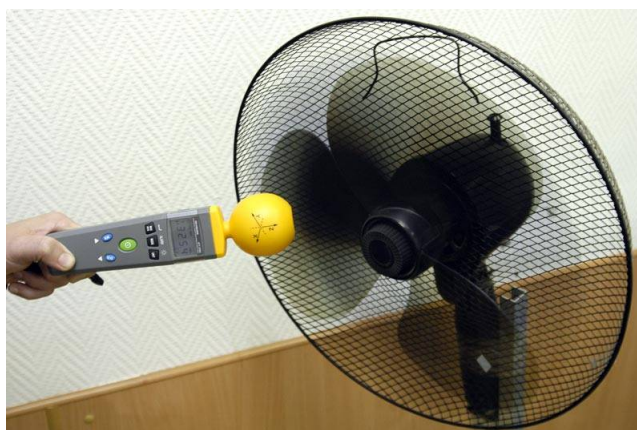
Измерение напряженности электрического поля выключенного вентилятора ("естественный" фон). Максимальное значение составляет 314,6 мВ/м
