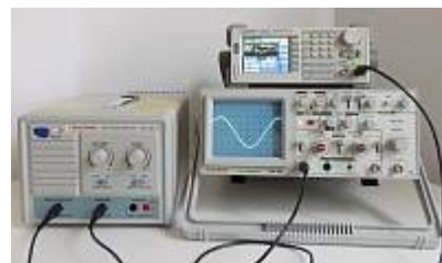
AVA-1810 Амплитудный усилитель - контроль усиленного сигнала
