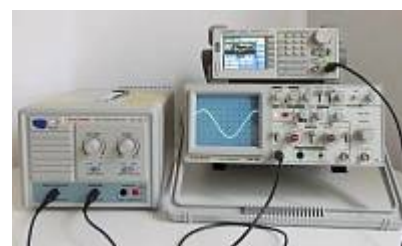
AVA-1810 Амплитудный усилитель - контроль усиленного сигнала
