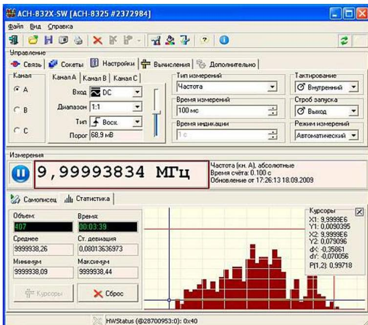
Частотомер может дистанционно управляться, не только по интерфейсу USB 1.1, но и подключаться к Ethernet через интерфейс LAN, что позволяет использовать частотомер в тех местах и в тех случаях, где присутствие человека затруднительно. Это позволяет существенно расширить сферу использования частотомера
