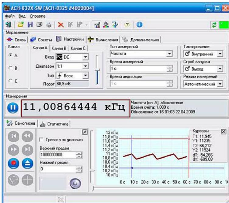
Центральная область рабочего окна - предназначена для запуска и остановки процесса измерения и отображения результатов измерений
