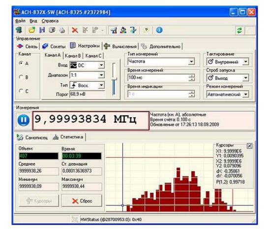
Частотомер может дистанционно управляться, не только по интерфейсу USB 1.1, но и подключаться к Ethernet через интерфейс LAN, что позволяет использовать частотомер в тех местах и в тех случаях, где присутствие человека затруднительно. Это позволяет существенно расширить сферу использования частотомера
